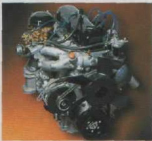
Самый «родной» двигатель «Волги» с ломовым моментом на «низах» — 3МЗ-402
