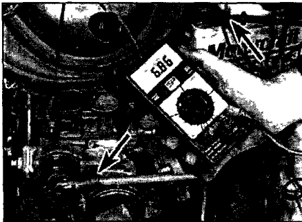
Рис. 5.5 Проверка напряжения на пусковом устройстве (двигатель работает)
